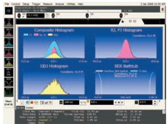
可使用 N5400A EZJIT Plus 对 5 Gbps PRBS 信号 进行总体抖动(Tj)分析(Dj/Rj)。深存储器使分析仪 能够显示低频抖动的成分。
